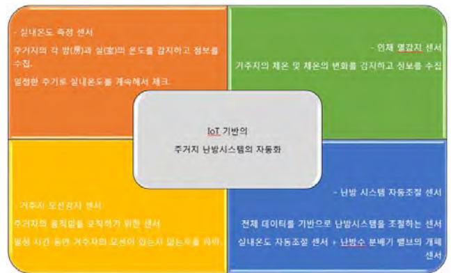
[그림 4] IoT 기반의 자동 난방 시스템.
