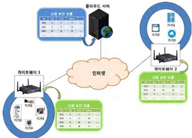
(그림 3) 신뢰 보안 모듈을 이용한 IoT 기기 간 원격 인증
