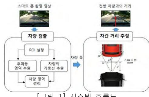
본 논문에서 제안하는 시스템 흐름도는 [그림 1]과 같다. 스마트 폰으로 촬영되는 영상에서 ROI(Region of Interest)를 설정하고, ROI에서 HSI 값을 이용하여 후미등을 추출하며, Canny 알고리즘을 이용하여 가로선을 추출한 후, 이 두 가지 수행결과를 이용하여 차량을 검출한다. 검출된 차량의 폭을
