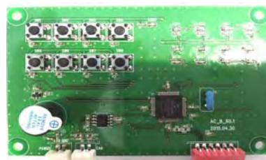
(그림 5-1)CAN 테스트 모듈
