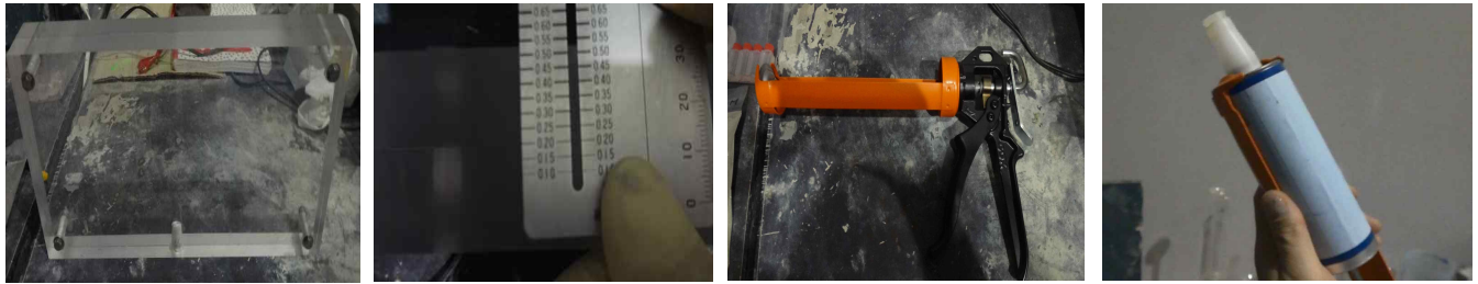
(a) 아크릴판 모의균열 시험체
