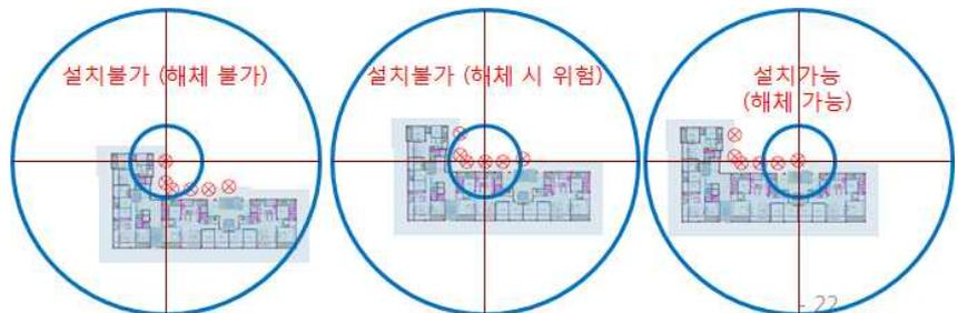
그림 3. 크레인 설치 포인트
