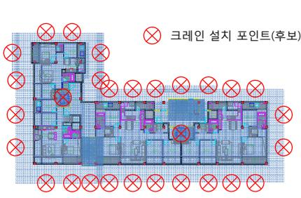
그림 2. 크레인 설치 포인트 도출
