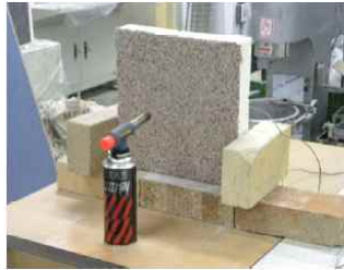
그림.3 경질우레탄 폼 50mm + 스톤코트 마감 가열 실험
