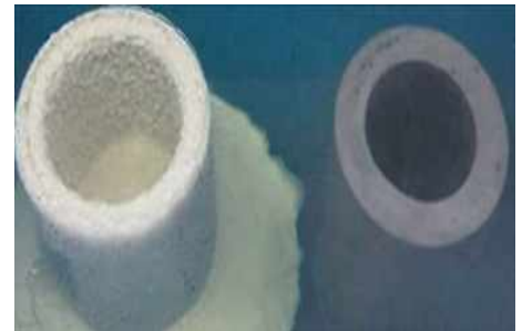
a) 시멘트모르타르 b) 무기바인더 그림 1. 10% H 2 SO 4 침지
