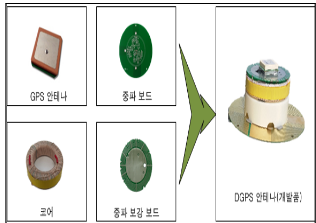
Fig.1 DGPS 안테나 설계.
