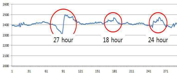
그림 2. 160 sq 케이블의 인공 열화에 의한 검출 데이터 Fig. 2. Detecting Data by Artificial Degradation at 160 sq cable
