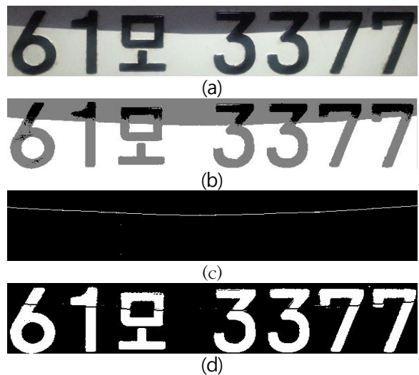
▶▶ 그림 5] (a) 원본 영상 (b) O, 128, 255값을 가진 영상 (c) 그림자 경계선 에지 (d) 제안하는 방법으로 이진화한 결과 영상
