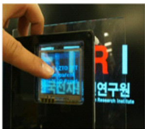
▶▶ 그림 4. ETRI에서 개발한 양면터치 투명 AMOLED패널
