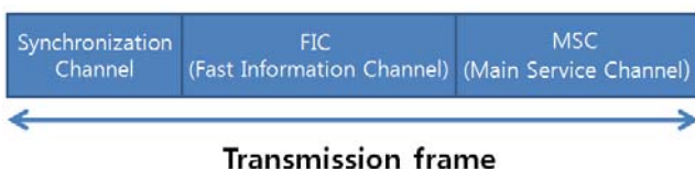
[그림 1] DMB 시스템 전송 프레임
