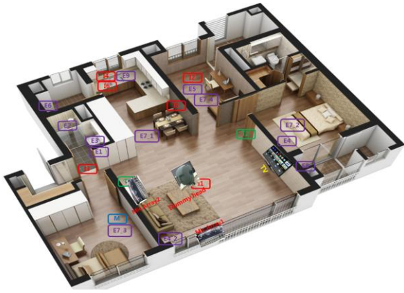
그림 1. 실내소음 DB 수집을 위한 공간 및 마이크 배치, TV 및 소음원들에 대한 위치 정보
