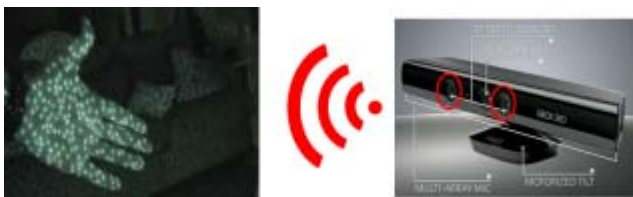
(그림 3) Kinect에 있는 3D Depth 센서에서 적외선 픽셀을 쏘아낸 모습
