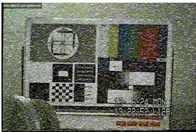
(그림 2) 고선량을 (95 Gy/h) 감마선 조사중인 저가 CMOS 카메라 관측영상
