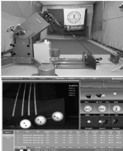
(그림 2) 로봇 스윙 머신과 임팩트 결과 화면
