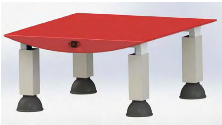
(그림2. 자동수평 유지 평판기구 설계 모형)
