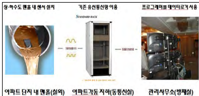
(그림 4)관교 산운마을 아파트 단지내 M2M/IOT 기반 하수(오수, 우수)도 맨홀 내 모니터링 시스템 구성도
