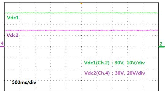
그림 4 셀 밸런싱 동작모드에서의 Vdc1, Vdc2 파형
