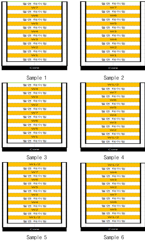
그림 2. 트랜스포머 샘플 내부 단면도
