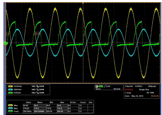
그림 7 9 : (34+34) 변압기의 실험파형 fig. 7 Experimental waveforms of the transformer
