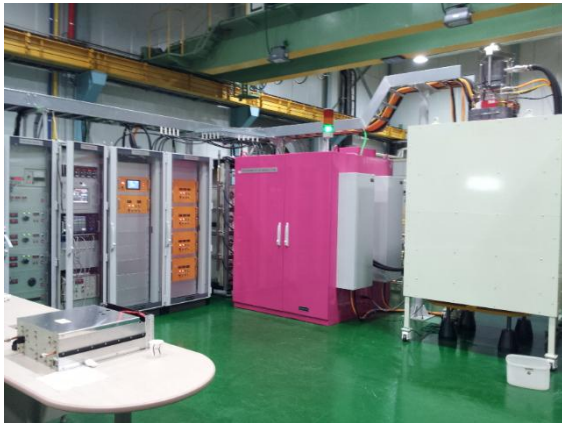
<그림 3> 인버터형 고정밀 고전압 전원장치 시험 설비
