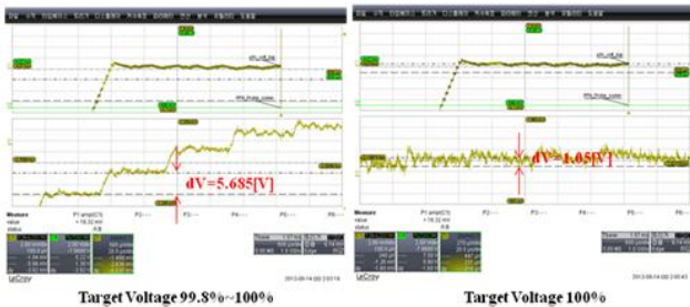
<그림 4> 큰용량 CCPS 스위칭시 PFN 충전 전압 및 Fine CCPS 충전전압 파형
