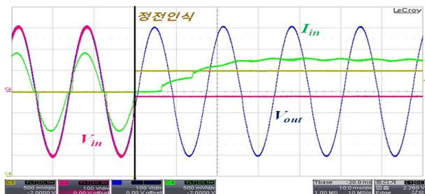
그림 5 정전 테스트 실험 파형
