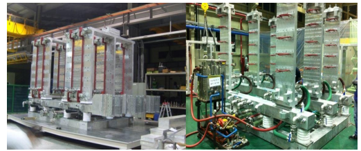
그림 1 AC/ DC Converter 구조물의 실 사진 Fig. 1 Photo of the AC/ DC converter structure
