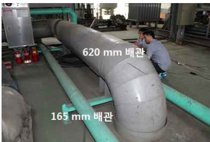
Fig. 3 진동신호기반 휴대용 감육배관 검사장치 검증 시험
