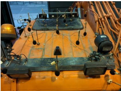
그림 2. Cabin Surface SPL Test
