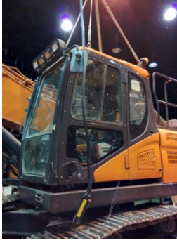
그림 1. Cabin Lift Noise Test
