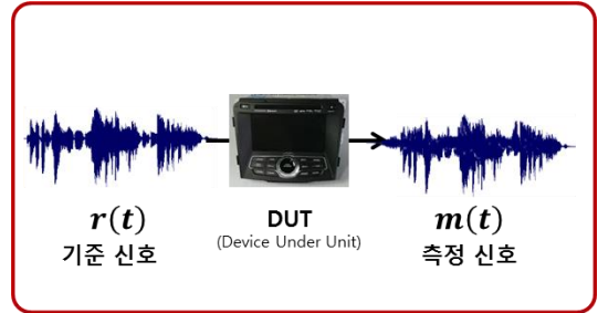
Figure 1. Configuration of system (noise)이 대부분이다. 본 논문에서는 차량용 오디오에서 재생될 수 있는 주파수 범위 내에서 주파수 특성이 일정한 백색 잡음을 유입되는 잡음으로 하여 차량용 오디오의 수신 성능을 정량화한다.
