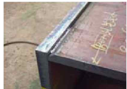
그림 1. CFT 기둥용 각형강관 용접방법
