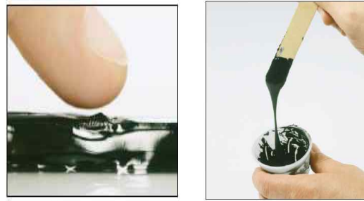
그림 3. 표면 경화 테스트와 스냅 타임 테스트 방법
