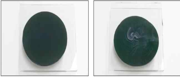
그림 5 혼합비 불균형에 따른 marbling현상, 우측
