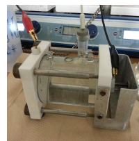
부식시험 셀 설치
