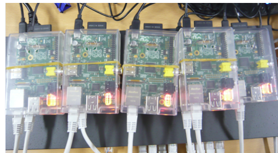
그림 1. 실험에 사용된 라즈베리 파이 클러스터 Fig. 1. The Raspberry Pi Cluster used for the Experiment
