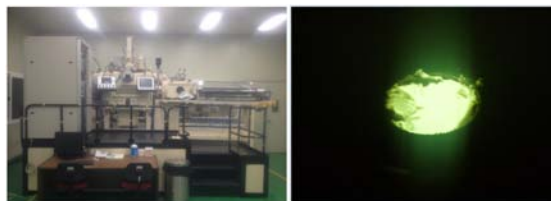
<EB-PVD 사진(좌) 및 전자빔을 이용한 피 코팅제 응용 사진(우) >
