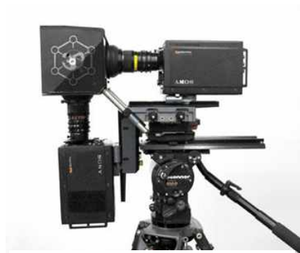
[그림 3]Bottom mount rig system의 모습
