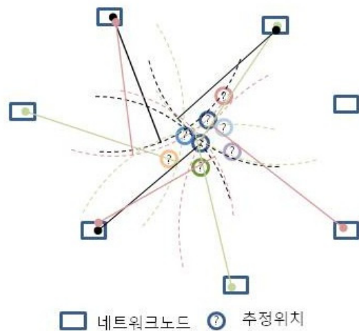
(그림 2) 다수의 노드를 이용한 위치추정 개념도 측정 오차가 존재할 수 있는 단 3개의 선발된 노드에서
