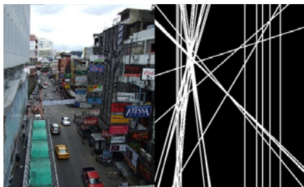
(그림 3) 원본 영상(좌)과 허프변환 통한 직선 검출 영상(우)
