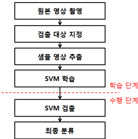
[그림 1] 제안하는 썬루프 검사 시스템의 전체 단계
