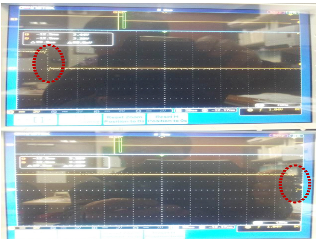
(그림 3) 32768Hz를 1/8로 분주한 타이머의 50 클럭 수 동안의 오차 측정(상:최대, 하:최소)
