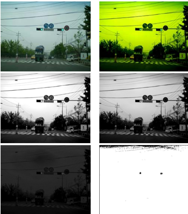
(그림 2) Spotlights 검출 결과 (위측,왼쪽: 원본, 색상조정, RGB 최대, Gray, 명도차이, 임계치)
