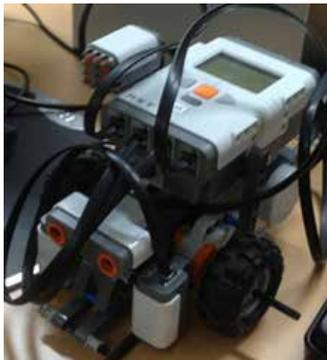
(그림 1) Lego 사의 Mindstorm 로봇
