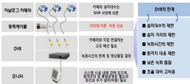
(그림 3.4) DVR 시스템 구성도
