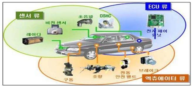
(그림 2.2) 자동차 전장 시스템 구성
