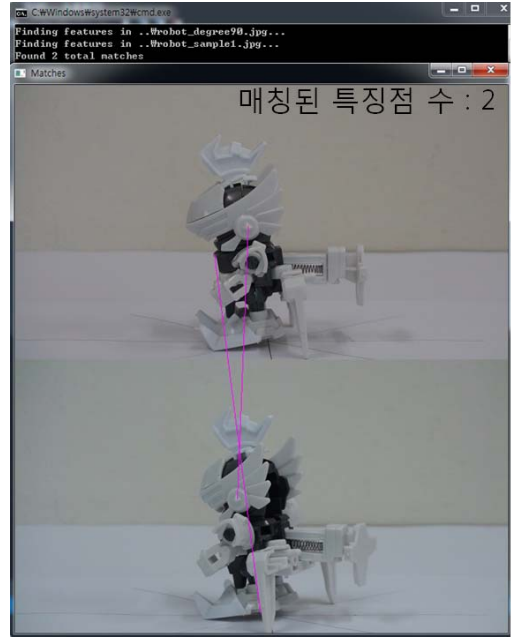
(그림 3) SIFT 특징점을 이용한 매칭 결과
