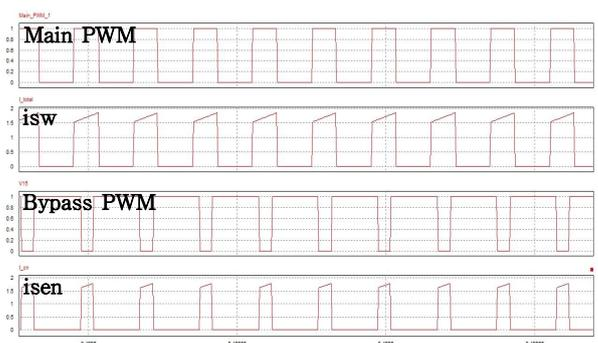
그림 2 제안된 평균전류모드제어 부스트 컨버터의 주요 파형
