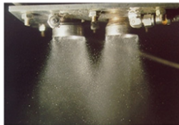
(d) Duplex형 air blast 연료노즐 및 스윌러
