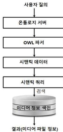
그림 3. 컨트롤 포인트 추가 구성 및 질의 과정
