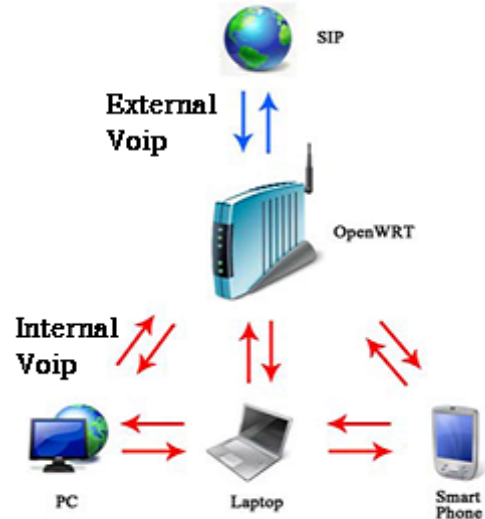
그림1. OpenWRT 기반 유무선 공유기 서버시스템 구성도
