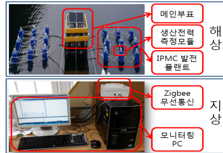
그림 2. 전체 모니터링 시스템 장치
