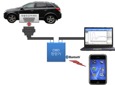
그림 2. OBD-II 및 블루투스 네트워크를 이용한 자동차 진단 개략도
