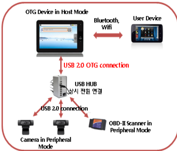
그림5. USB OTG(On-The-Go) System Configuration
